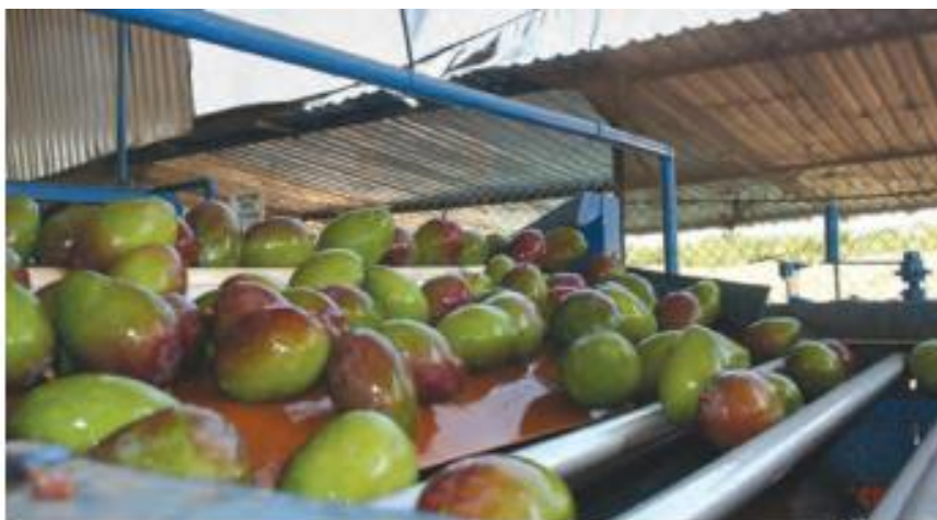
Clasificación de frutos por peso (foto superior) y por tamaño (foto inferior)
